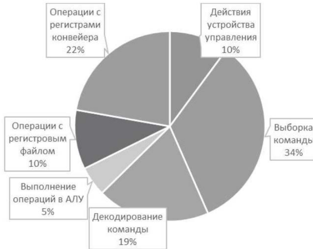
Рис. 16. Примерное соотношение времени работы различных вспомогательных действий при выполнении инструкции микропроцессора с архитектурой Фон-Неймана [21].
