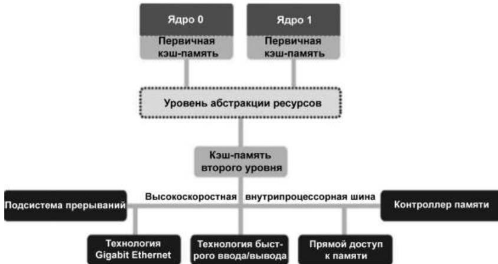
Рис. 15. Структура типового многоядерного процессора [20].
