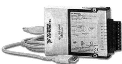
Рис. 7. Устройство USB-9215А
