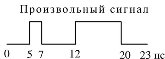
Рис. 4.10. Форма произвольного сигнала
