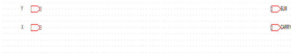
Рис. 18.26. Заготовка для схемы полусумматора
